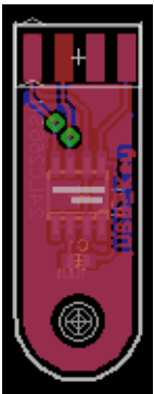
5. ábra A KötED által kezelt szövőgép mintatároló Flash memória "kulcsa"
