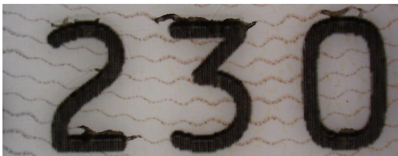
1. Ábra: Műanyag kártyák lézergravírozása során fellépő beégés jelensége
