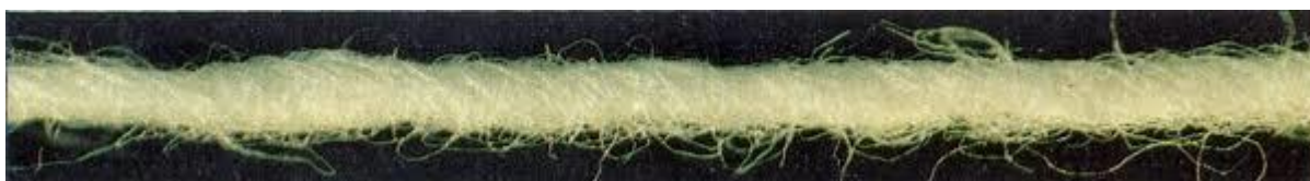
2. Egy átlagos, vágott elemi szálakból álló fonal képe [ http://www.roltex.hu/textilipari_leirasok/fonal/ ]
