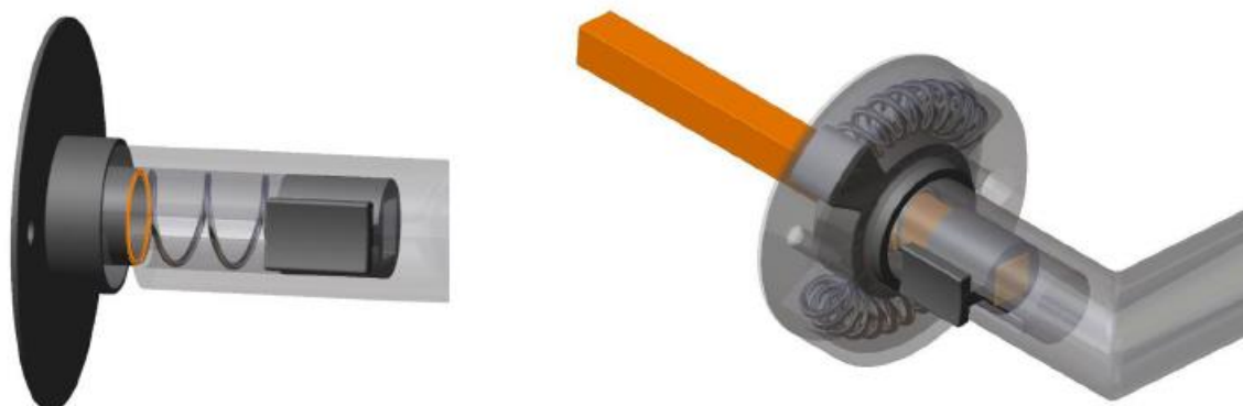
6. ábra: Carolin Deutsch (2021): A biztonsági ajtókilincs végső kialakításának részletrajzi
