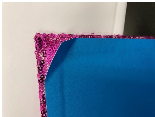
7. ábra: A 6. minta sarkán levált előzék
