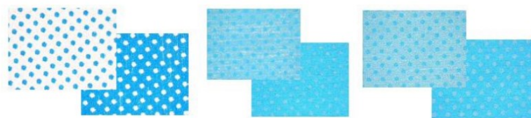
13. ábra: Az Agfa N91v referencia- valamint a Fujifilm LP-NV nyomólemezek 20% illetve 80%-os kitöltési arányú területének videomikroszkópos felvételei
