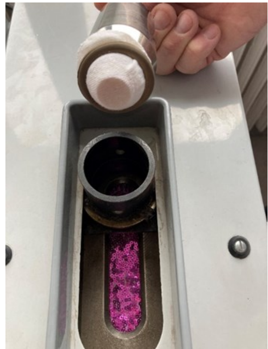
3. ábra: Az 1. számú mintadarab koptatása
