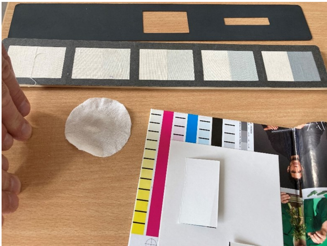
5. ábra: A 10. mintatest koptatás utáni tesztábrával való összehasonlítása
