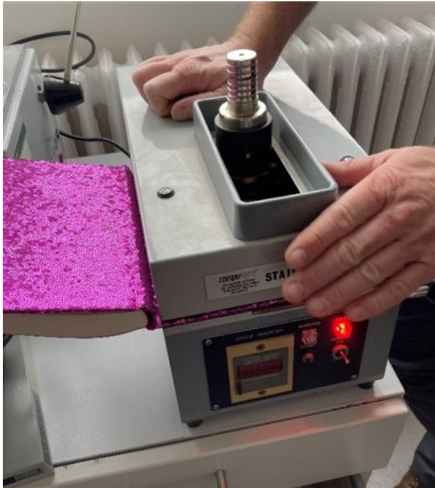
3. ábra: Az 1. számú mintadarab koptatása
