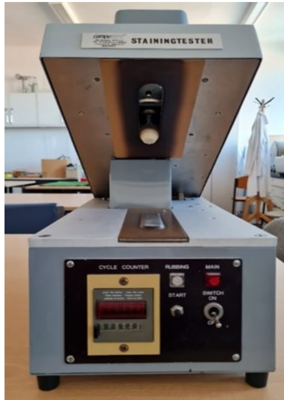
1. ábra: FD17/A Stainingttester típusú koptató berendezés
