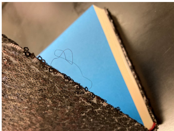
4. ábra: A 3. minta kiszálasodása az élnél
