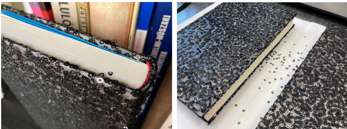
10. ábra: A 2. számú minta 20 berakás/kivétel, majd a tartóssági vizsgálat elvégzése után a lehullott flitterekkel
