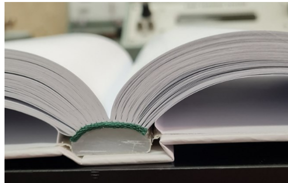
2. ábra: Az 1. számú minta gerincdőlése a vizsgálat során
