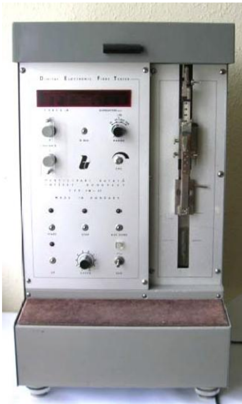
7. ábra: Az eredeti FM-27 elemiszál-szakító gép
