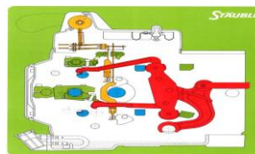
10. ábra: Stäubli 2232 típusú nyüstösgép vázlat
