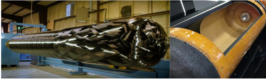
9. ábra: Szénszállal erősített hidrogén tartály kialakítása és metszeti képe
