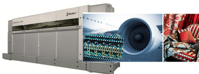
23. ábra: Stäubli UNIVAL Jacquard gép és alkalmazása
