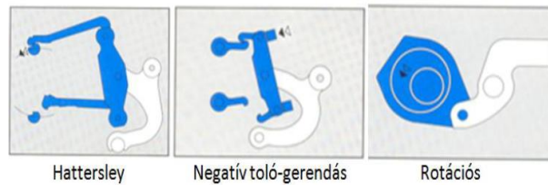
8. ábra: Kétütemű nyüstösgépek működési elve
