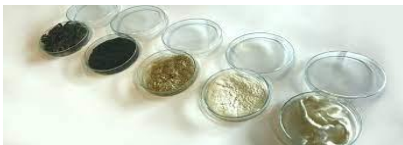
1. ábra: Szárított tengeri algából textil szál
