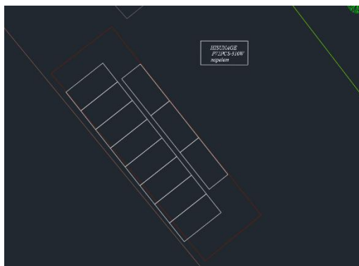
4. ábra: Napelem elrendezés a 13-as parcellán elhelyezkedő közösségi épületen
